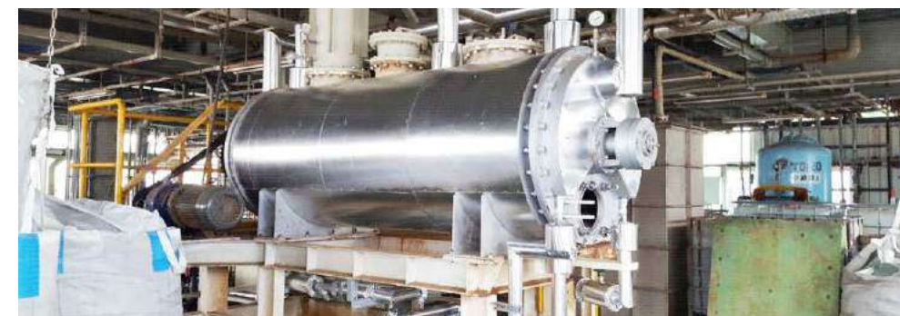
污泥乾燥機設備
