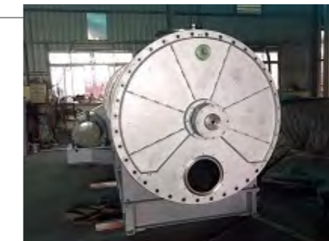
污泥乾燥機設備
